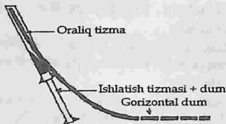
8.1-rasm. Derazani oraliq tizmasi chegarasida ochish
