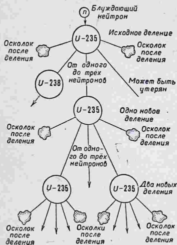
Рис. 131. Цепная реакция в Уране-235.
