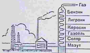
Рис. 110. Схема крекинга нефти.
