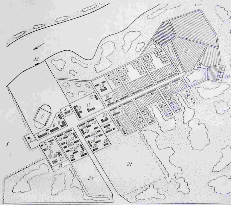
Рис. 3.22. Схема типового генерального плана поселка глубинного типа, застроенного двухэтажными жилыми зданиями:
