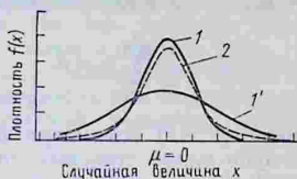
Рис. 6 1 и 1' — функции плотности нормального распределения с дисперсиями \sigma_1 > \sigma_2
