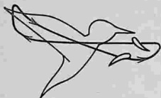
Рис. 13. Траектория и повороты сечения крыла колибри в режиме висения
