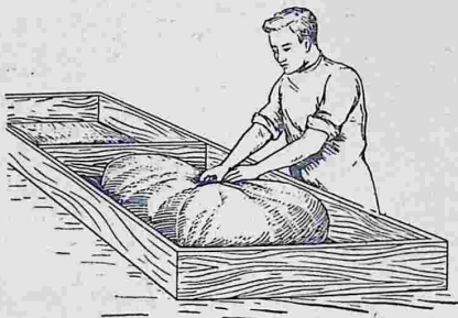
Рис. 87. Завертывание сырной массы перед прессованием.
