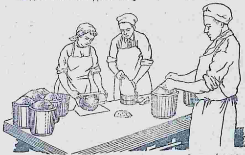
Рис. 84. Завертывание головок сыра в салфетки (слева направо: приемы первый, второй и третий).
