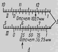
Рис. 6. Штангенциркуль ШЦ-1 (а) и примеры отсчета (б):
