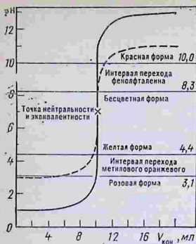
Рис. 6.2. Кривые титрования 0,1 М раствора HCl 0,1 М раствором KOH (сплошная линия) и 0,001 М раствора HCl 0,001 М раствором KOH (пунктирная линия)
