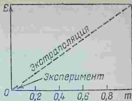
Рис. 3.13. Определение эбулиоскопической постоянной экстраполяцией
