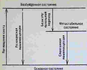
Рис. 2.2. Схема возникновения резонансной и спонтанной люминесценции
