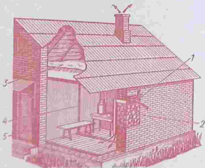
Рис. 22. Приспособление комнаты жилого кирпичного дома под укрытие:
