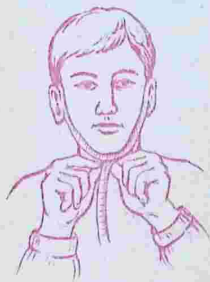
Рис. 38. Измерение головы при подборе шлем-маски противогаза ГП-5.
