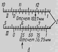
Рис. 6. Штангенциркуль ШЦ-1 (а) и примеры отсчета (б):
