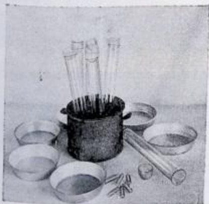
Рис. 34. Оборудование для варки льна.
