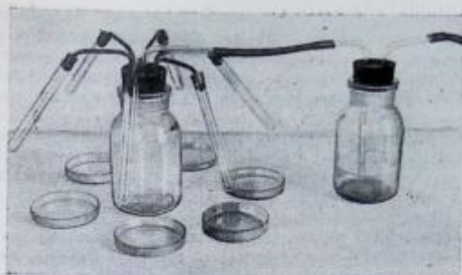
Рис. 28. Прибор Госкомиссии по сортоиспытанию сельскохозяйственных культур для определения плесчатости ячменя.
