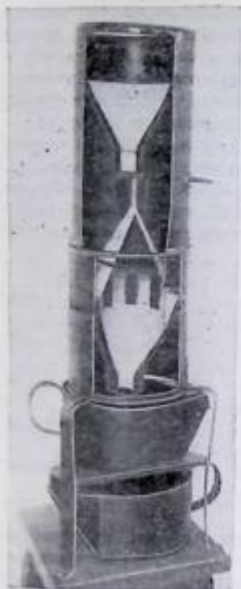
Рис. 175. Канадский делитель (разрез).
