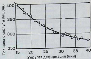
Рис. 5. Упругая деформация и толщина скорлупы яиц (калибровочная кривая)
