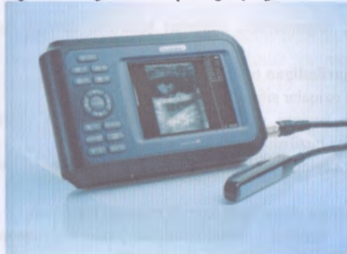
2-rasm. Hayvonlarda bo'g'ozlikni aniqlash uchun "HandSkan V8" UTT asbobi.
