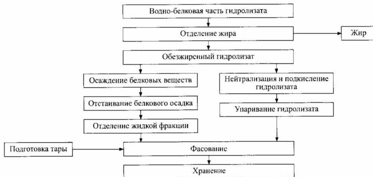
Рис. 11.5. Схема производства белково-витаминной кормовой пасты
