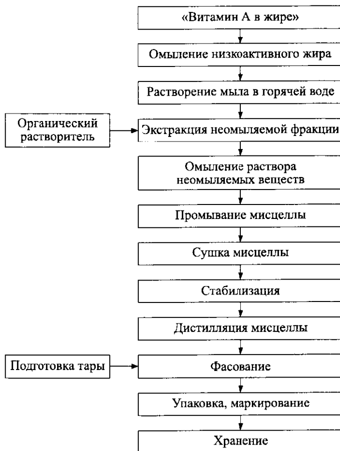
Рис. 11.10. Технологическая схема производства концентрата витамина А способом щелочного омыления
