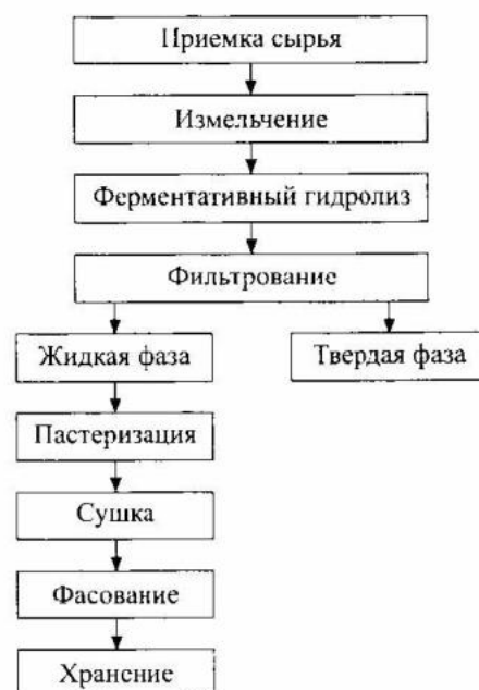
Рис. 11.3. Технологическая схема производства заменителей молока с использованием ферментных
