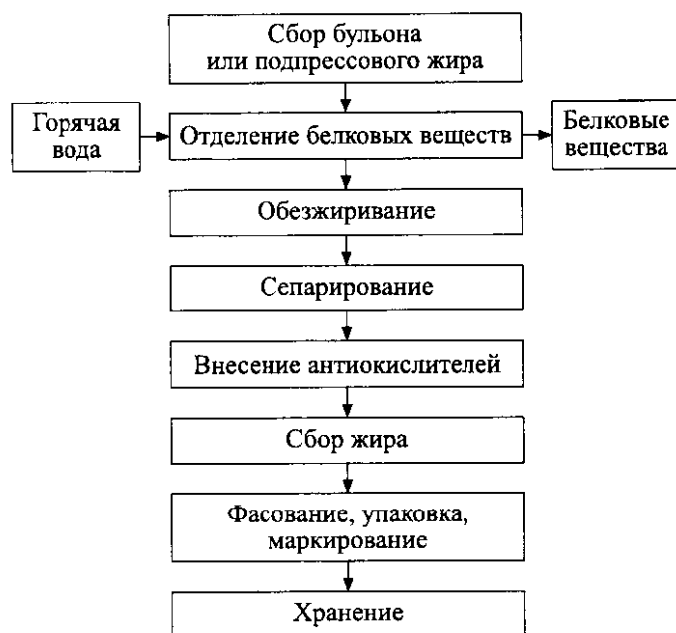
Рис. 11.6. Технологическая схема производства технического рыбного жира
