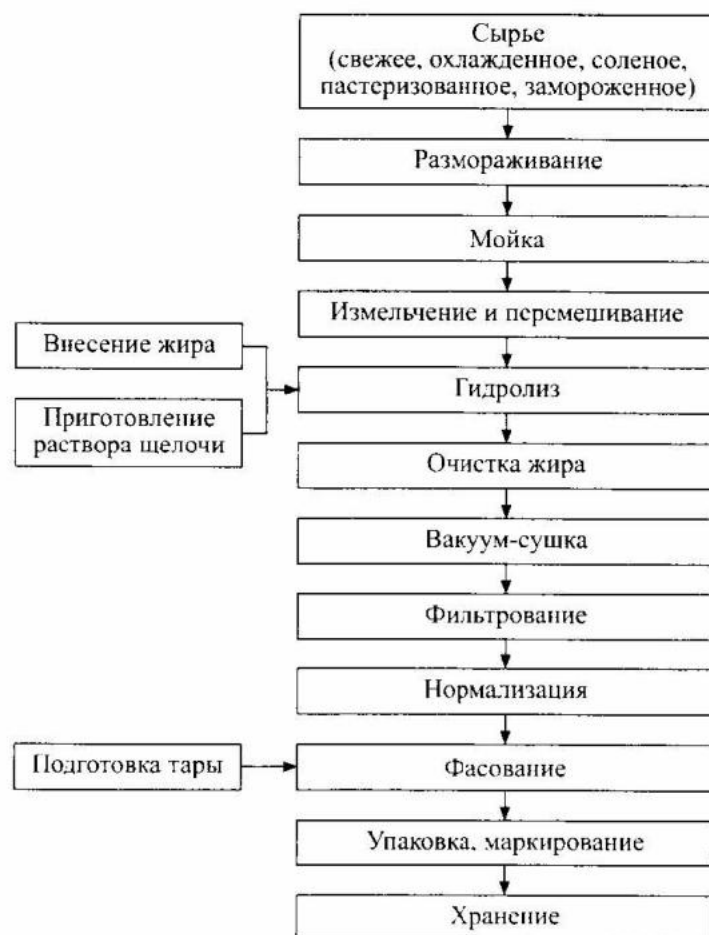
Рис. 11.9. Технологическая схема производства препарата «Витамин А в жире» гидролитическим способом
