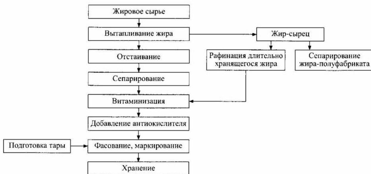
Рис. 11.8. Технологическая схема производства ветеринарного жира
