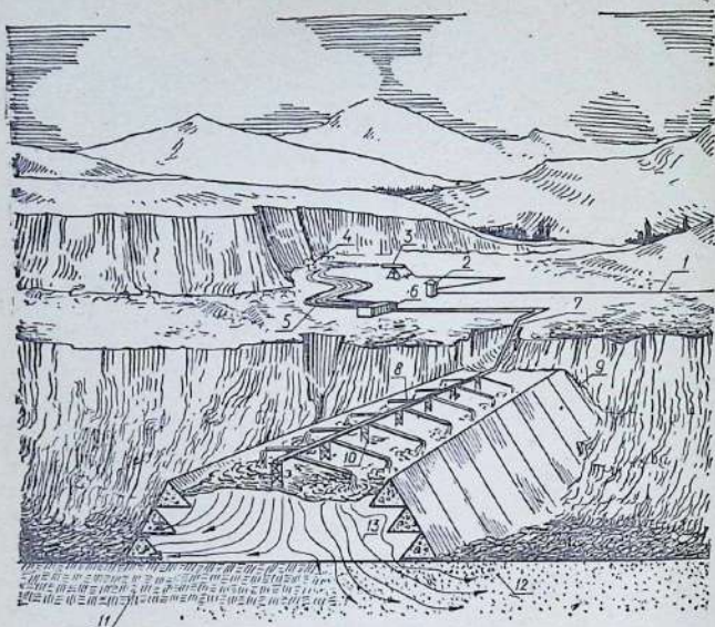
137- расм. Тупроқ оқизиш ва шу тупроқ билан тўғон қуриш схемаси
