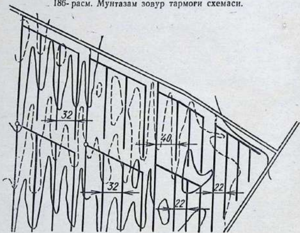
187- расм. Сийрак зовур тармони схемаси.
