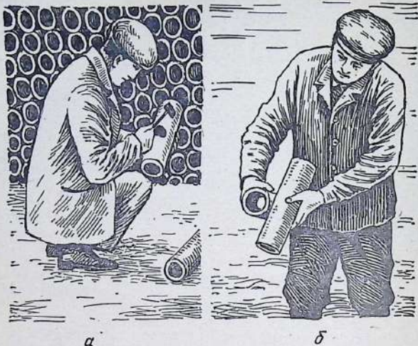
197-расм. Қувурни тешиш (а) ва тешикка иккинчи қувурни мослаштириш (б).
