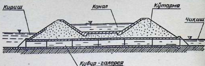
115- расм. Кўтарма канал остига ётқизилган қувурнинг (галереянинг бўйлама қирқими.
