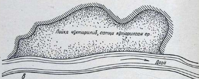
220- расм. Лойқа чўктириш йўли билан территория сатҳини кўтариш: а — пастликка сув оқизиб юборилган; б — лойқа чўкиб, дарёнинг янги ўзани пайдо бўлган; в — лойқага тўлиб қолган пастлик.
