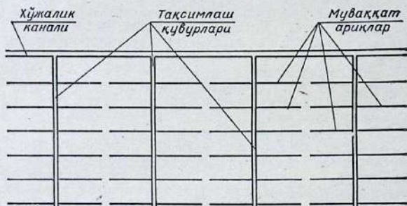
76-рasm. Комбинация қилинган тармоқнинг планда жойлаштириш схемаси.
