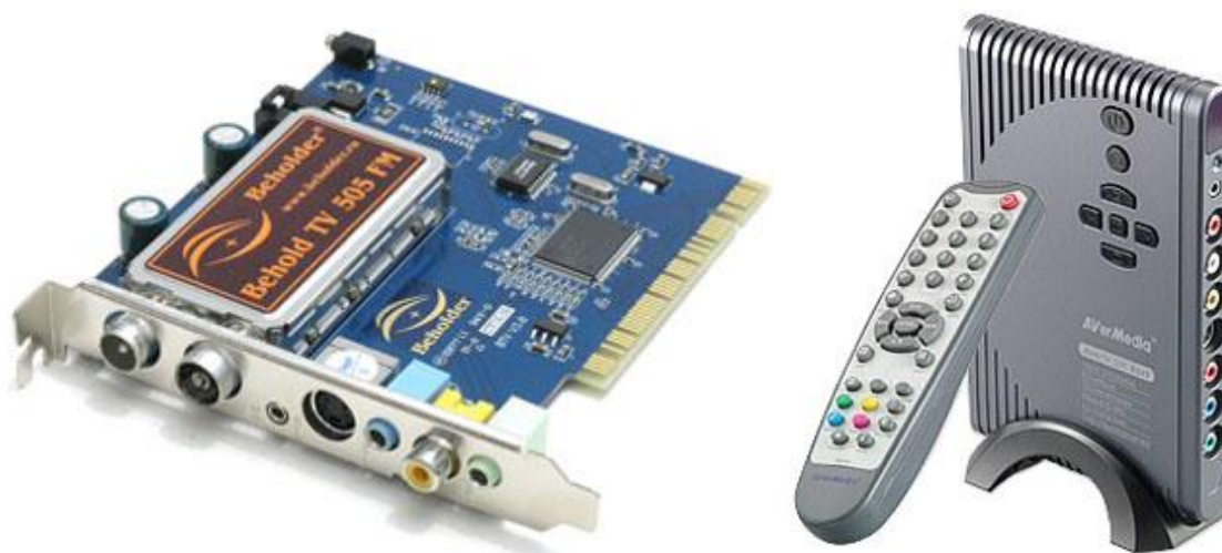
Рис. 5.20. Типы видеотюнеров – встроенный, внешний
