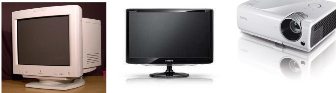
Рис. 5.17. Типы мониторов ЭЛТ, ЖК, проекционный
