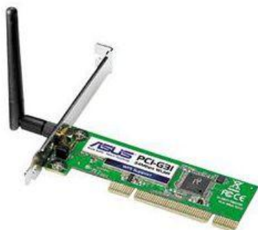
Рис. 6.11. WiFi-адаптеры: внутренний и внешний USB-адаптер
