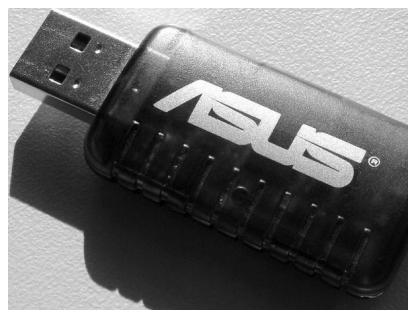
Рис. 6.11. WiFi-адаптеры: внутренний и внешний USB-адаптер
