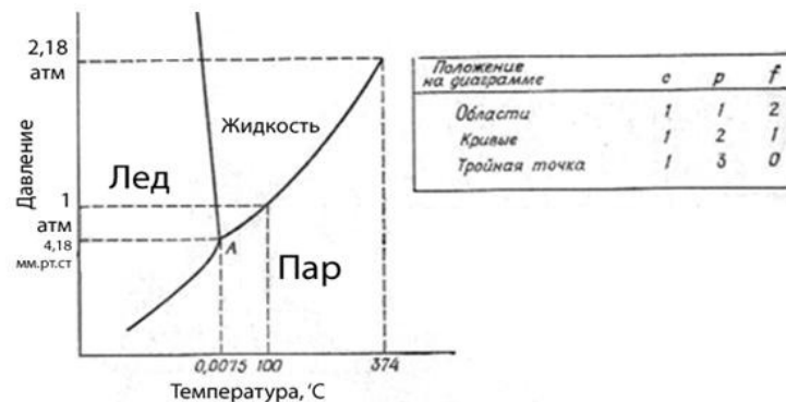
Рисунок 4.1 — Схема фазовых переходов для однокомпонентной системы — воды
