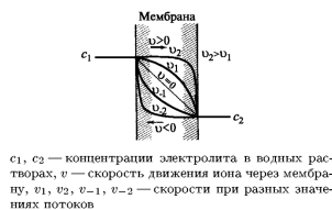
Рисунок 6.1 — Распределение концентрации ионов внутри мембраны в зависимости от направления и скорости протекания жидкости
