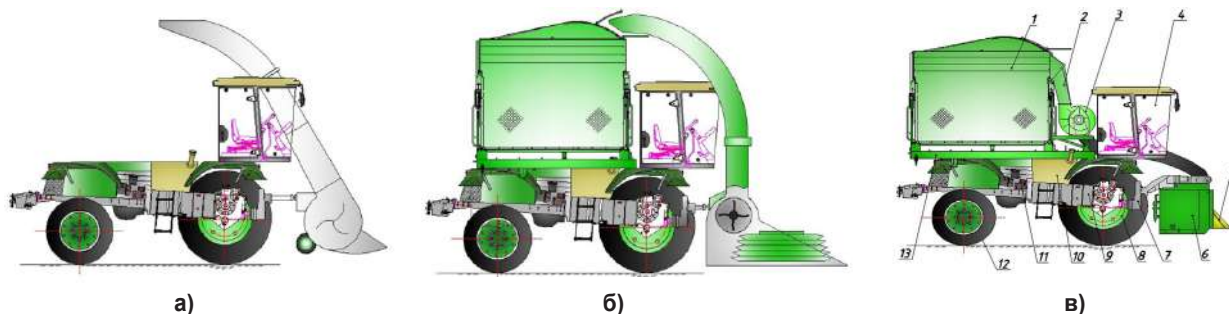
1-расм. ТТЗ(МТЗ) тракторлари базасидаги УЭВ нинг таклиф қилинаётган компоновка схемалари:
