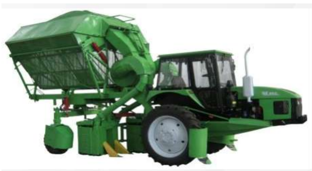
1-расм. МХ-1,8 русумли вертикал-шпинделли сериядаги пахта териш машинаси (90 см қатор орасида экилган пахталар учун)
