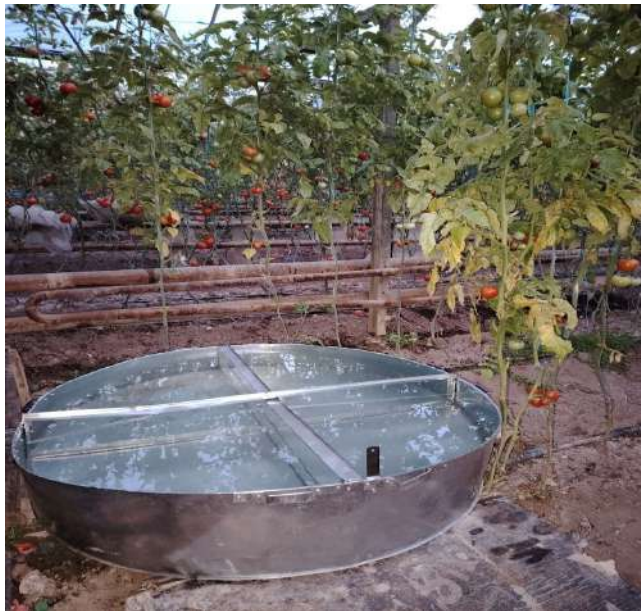
1-rasm. A Pan bug‘latgichini issiqxonada qo‘llash jarayoni
