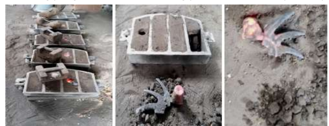
2-rasm. Quyma rotatsion yulduzchalarning takomillashtirilgan variantini olishni texnologik jarayonlari: a-er formasida formovka qilish va suyuq metall quyish; b-formadan ajratib olingan yulduzcha; v-quyma tayyor rotatsion yulduzchani ko‘rinishi.
