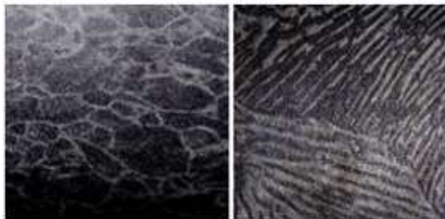
4-rasm. Tarkibida 0,3-0,4 foizgacha uglerodi bo'lgan po'lat (a) va plastinkasimon perlit strukturali (b) ko'rinishlari.
