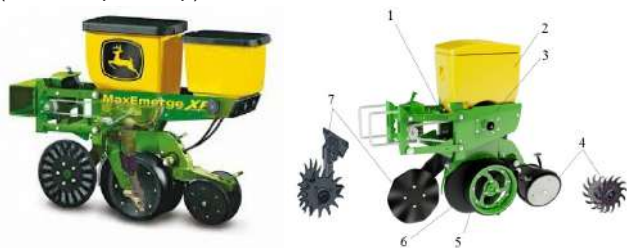
а-JohnDeere фирмасининг 1705-1795 русумли сеялкаларининг экиш модули; б-KUHN фирмаси сеялкалари 1-осгич; 2-бункер; 3-Precision planting миқдорлаш аппарати; 4-текис сиртли ёки игнасимон тишли ғалтакча; 5-зичлагич ғилдиракча; 6-диски экич; 7-тозалагич-юмшаткич ёки тупроқ юмшаткич диски
