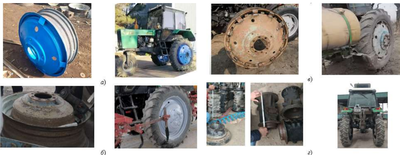
Расм. Уч ғилдиракли чоқиқ тракторларини 76 см ли қатор ораларида ишлатиш учун орқа етакчи кўприк енглари ва дисklarининг турли вариантлардаги кўринишлари
