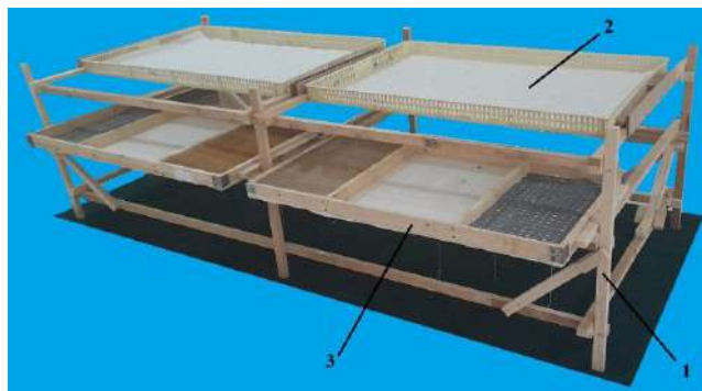
2-расм. Пиллаларни капалак даврида жинсларга ажратувчи ва папильонаж ишларини ўтказувчи папильонаж ускунанинг тажриба нусхаси.
