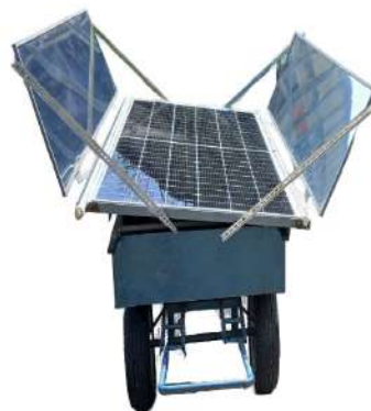
1-rasm. Kristalli kremniy asosidagi 540 W lik mobil FEIB ning tashqi ko‘rinishi. Qiya tekislikdagi yerlarni tomchilatib sug‘orishda, elektr energiyasi va cheklangan miqdordagi ssiq suv olishda foydalaniladi.
