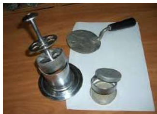
1-rasm. Ichki diametri 50 mm dan kam bo‘lmagan metall keskich halqa va grunt olgich qurilmasi.
