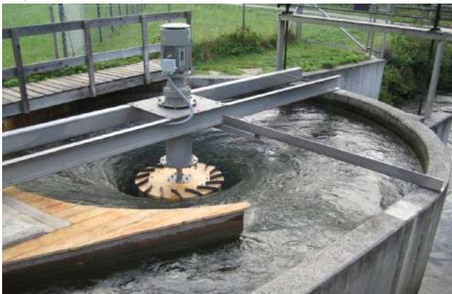
1-rasm Qishloq xo‘jaligi maydonlarida mini gidro elektr stransiyasi
