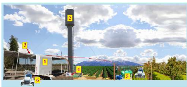
Рисунок 3. Мобильная электростанция «Солнце-ветер» и ее применение при капельном орошении где 1-мобильная электростанция «Солнце ветер»; 1 –водонасосная башня; 3 – солнечные батареи; 4,5 – система капельного орошения и шкаф для ее электроснабжения; 6-зарядное устройство для электротракторов.
