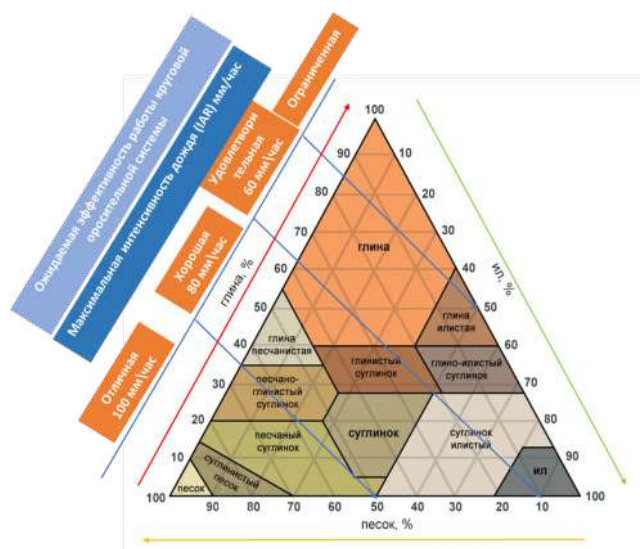
1-rasm Tajriba dalasidan olingan tuproqlarni uchburchak diagramma usulida aniqlash
