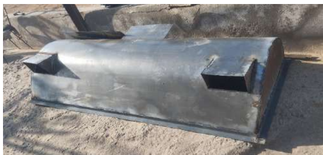
1-rasm. Tajriba uchun tayyorlangan shnekli-qoziqli tituvchi moslama. a) shnekli-qoziqli titkilash moslamasi; b) pnevmo-ta'minlagich.
