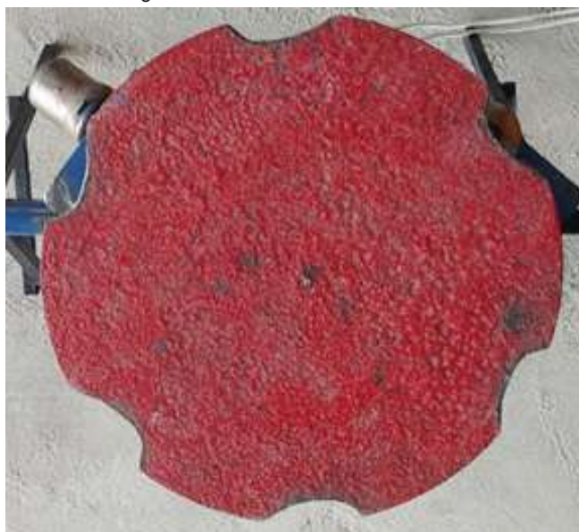
2-rasm. Aylanuvchi taglikda hosil qilingan o'yiqlar joylashishi
