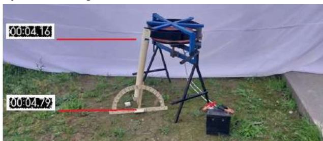
5-rasm. Yo‘naltiruvchi novning turli vertikalga nisbatan og‘ish burchaklarida tadqiq qilish jarayoni
