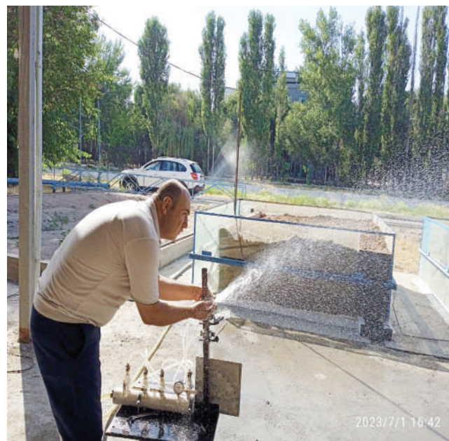
5-rasm. Yomg'irlatib sug'orish qurilmalari uchun qamrash kengligini oshirish moslamasini tadqiqotlarini olib borish uchun laboratoriya stendi:
