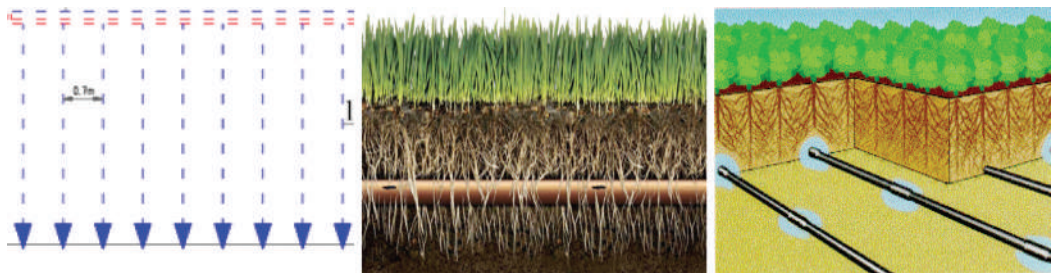
1-rasm. tuproq ichidan sug'orish tizimining tomizgichli shlanglarni joylashtirish sxematik ko'rinishi
