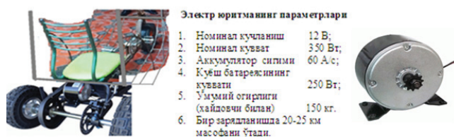
3-расм. Дала ишлари учун мобил электромеханик қурилманинг ҳаракатлантириш қисми ва умумий кўриниши.
