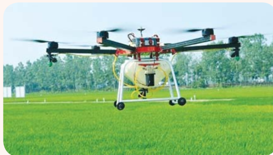
Расм. Экспериментал учувчисиз учиш аппарати «AGRODRONE»
