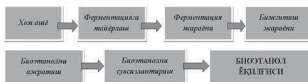
Расм. Картошкadan биоэтанол ишлаб чиқаришнинг технологик схемаси..
