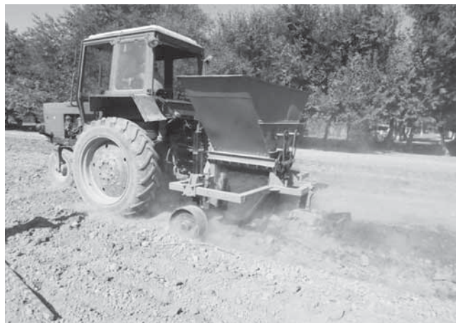
1-расм. Ўғитлагич қурилманинг иш жараёнидаги кўриниши (4- ва 5-узатмалари).
