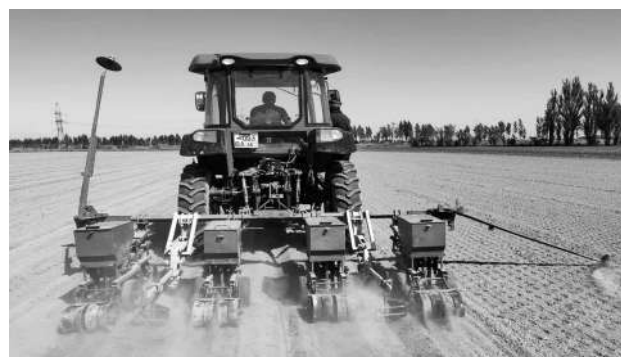
1-расм. Пахта чигити ва соя уруғини бир вақтда экувчи секцияли сеялка ЧСС - 4Х нинг ишлаши
