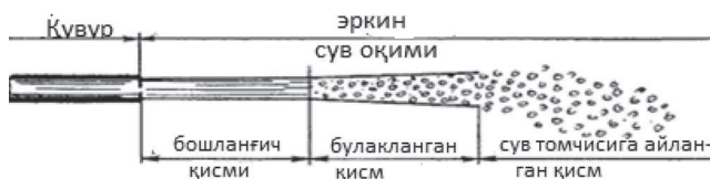
1-расм. Дефлектор насадкали соплодан отилиб чиқаётган сув оқимининг турли фазалардаги ҳаракати.
