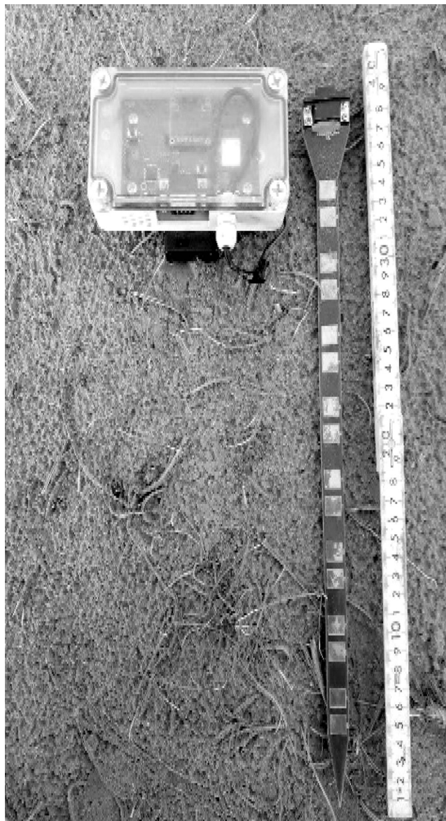
1-rasm. Namlik aniqlovchi uskuna (Horiba, Yaponiya).
