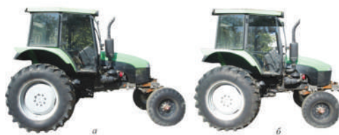
Рис. 1. Универсально-пропашной трактор с изменяемой базой в приращенной (а) и укороченной (б) базе.
