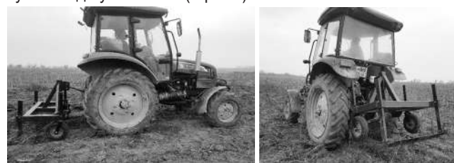
3-расм. Универсал илди́змева ковлагичнинг дала тажрибасини ўтказиш жараёни.
