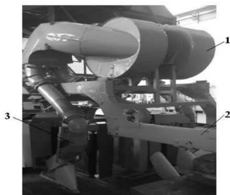
Рис.1. Общий вид экспериментальной комбинированной машины: МХ-1,8М: 1-вентилятор; 2-рама; 3-пневматическое всасывающее устройство.
