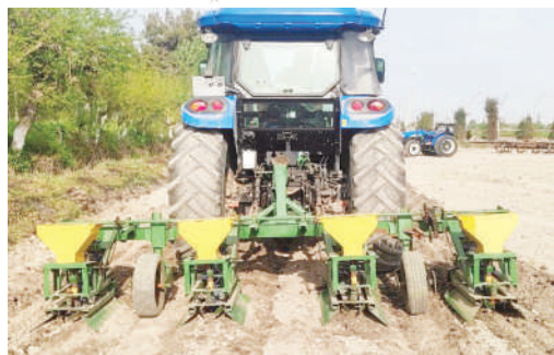
5-расм. Кузда олинган пуштани самарали шаклини сақлаган ҳолда экувчи секцияли сеялканинг кўриниши (а) ва ишлаши б)
