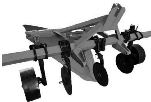
6-rasm. Disklar bilan takomillashgan muvaqqat ariq qazgichning umumiy ko'rinishi.
