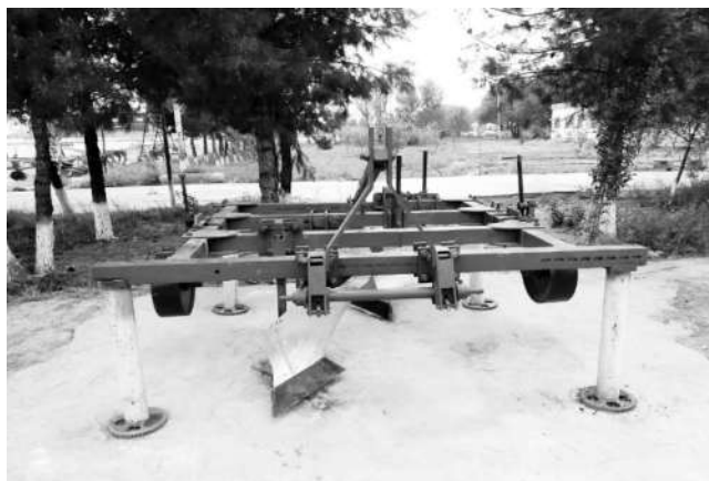
1-rasm. Yopiq va yarimochiq kesish sharoitida egatsiz tekis shudgorlaydigan plugning old tomonidan ko'rinishi.
