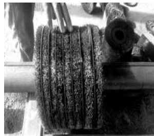
2-расм. Валга аррали ва чўткали дискларни кетма-кет ўрнатиш жараёни.
