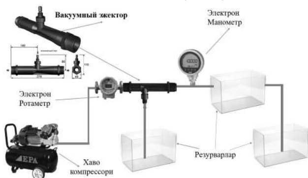
1-расм. Суғориш тизимларини гидромеханизация усулида тозалаш лаборатория қурилмаси чизиқли схемаси.
