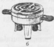
41-rasm. Elektr plitkalar: a-yopiq tipdagi; b-ochiq spiralli
