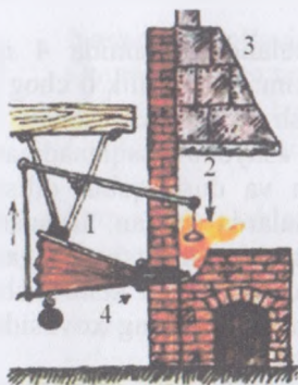
19–rasm. Doimiy temirchilik o'chog'i. 1–bosqon. 2–gomini. 3–konussimon mo'ri. 4–furna.
