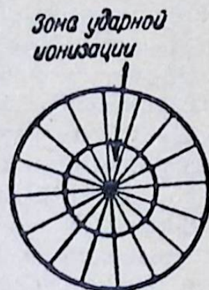
Рис. 14. Поперечное сечение счетной трубки с изображением расположения силовых линий.
