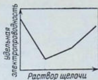
Рис. 11.7. Вид кривой при кондуктометрическом титровании слабой кислоты сильным основанием.
