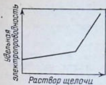
Рис. 11.7. Вид кривой при кондуктометрическом титровании слабой кислоты сильным основанием.
