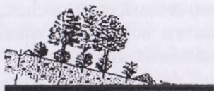
15-rasm. Qiyaligi 15° bo'lgan yerlarda o'rmon daraxtlari, suv to'sar ariqlar, yaylov-pichanzorlarni joylashtirish tizimi.
