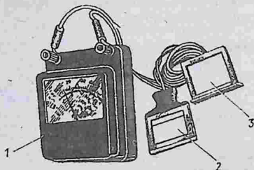
Расм 4.13. Ю-16 фотоэлектрик люксметрнинг ташқи кўриниши. 1-гальванометр; 2,3-селенли ёруғлик ютувчи фотоэлементлар.
