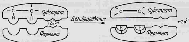
Рис. 36. Ион цинка в качестве активатора при образовании комплекса фермент — субстрат
