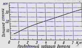
Рис. 3. График для определения толщины стенки детали из серого чугуна
