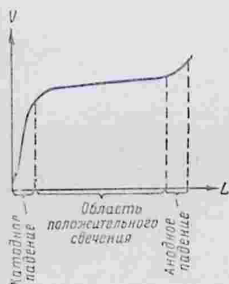
Рис. 172. Падение потенциала вдоль разрядной трубки.
