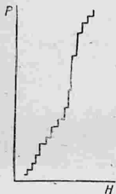
Рис. 225. Скачкообразное нарастание намагничивания ферромагнетика.
