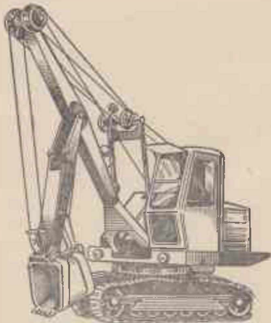
Рис. 70. Экскаватор универсальный на гусеничном ходу Э-303В с ковшом емкостью 0,4 м 3 .
