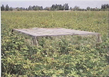
2.18-расм. Пахта даласига ўрнатилган 2x3 м ўлчамдаги ва баландлиги 1,2 м бўлган, 2,5 мм кўзли металл тўрли каркасли изолятор.
