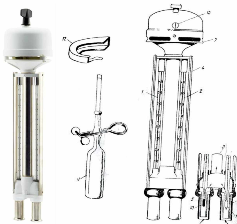
26-rasm. MV-4M Aspiratsion psixrometri va uning tuzilishi: 1-termometr, 2-quruq va hullangan termometrlar; 3-trubka; 4-yon tomonlardagi himoya 5 va 6-trubkalar; 7-aspirator; 8-kalit; 9-ichaksimon rezinka nok; 10 va 11-termometrlar rezervuari; 12-shamoldan saqlagich; 13-tirqish.
