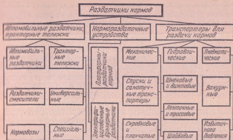
Рис. 50. Классификация раздатчиков кормов.
